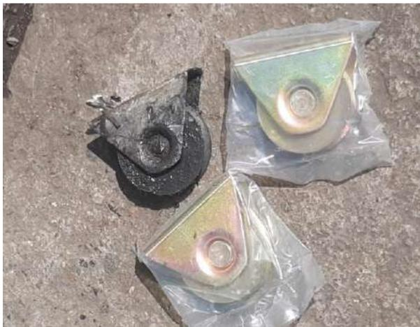
Se realizó por medio de contratación externa, el cambio de las rodachinas de la reja principal de ingreso al área de urgencias, las cuales se reemplazan debido a que se estaban pegando por culminación de su vida útil
